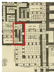
Fig.68. Escalier en deux parties
